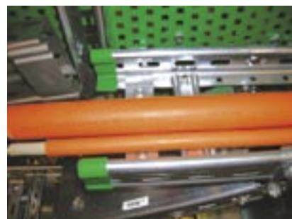
Рис. 11. Негорючие кабели, выдерживающие 90 минут контакта с пламенем, на стенде компании «ТФ-кабель»
