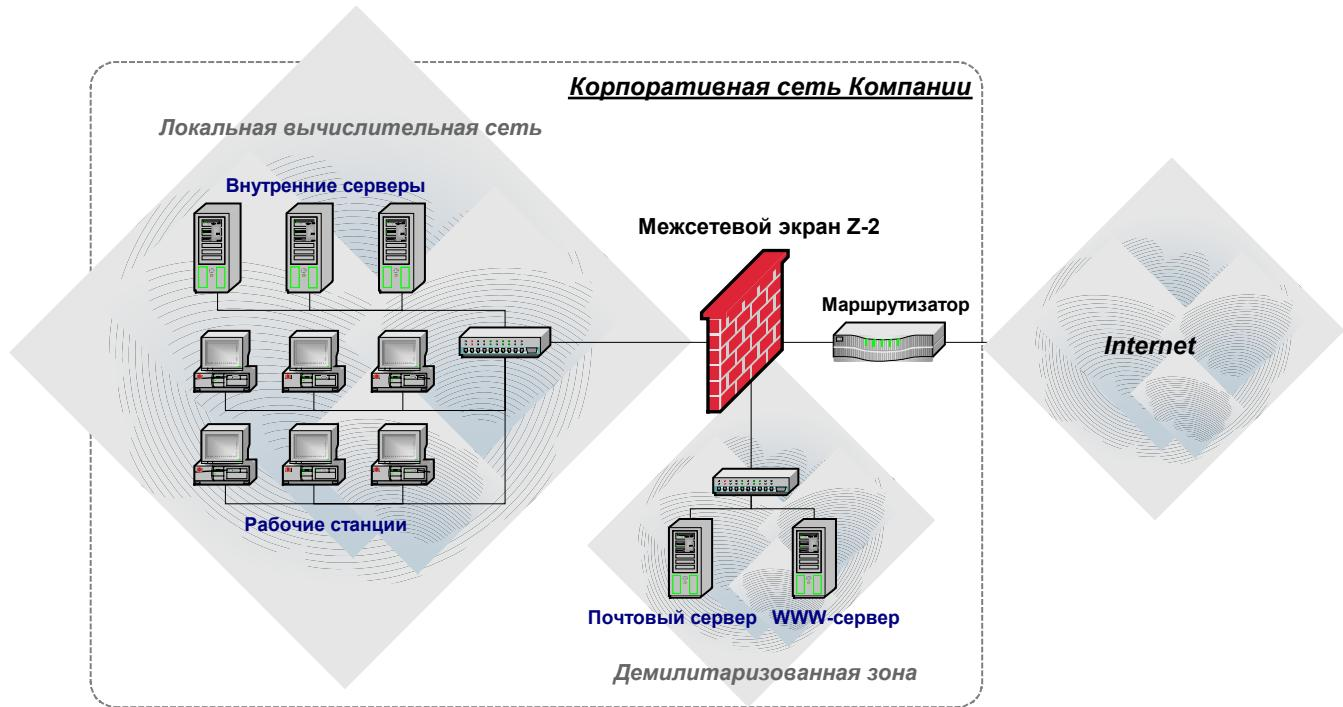
Рис. 1. Общая схема подключения межсетевого экрана Z-2
