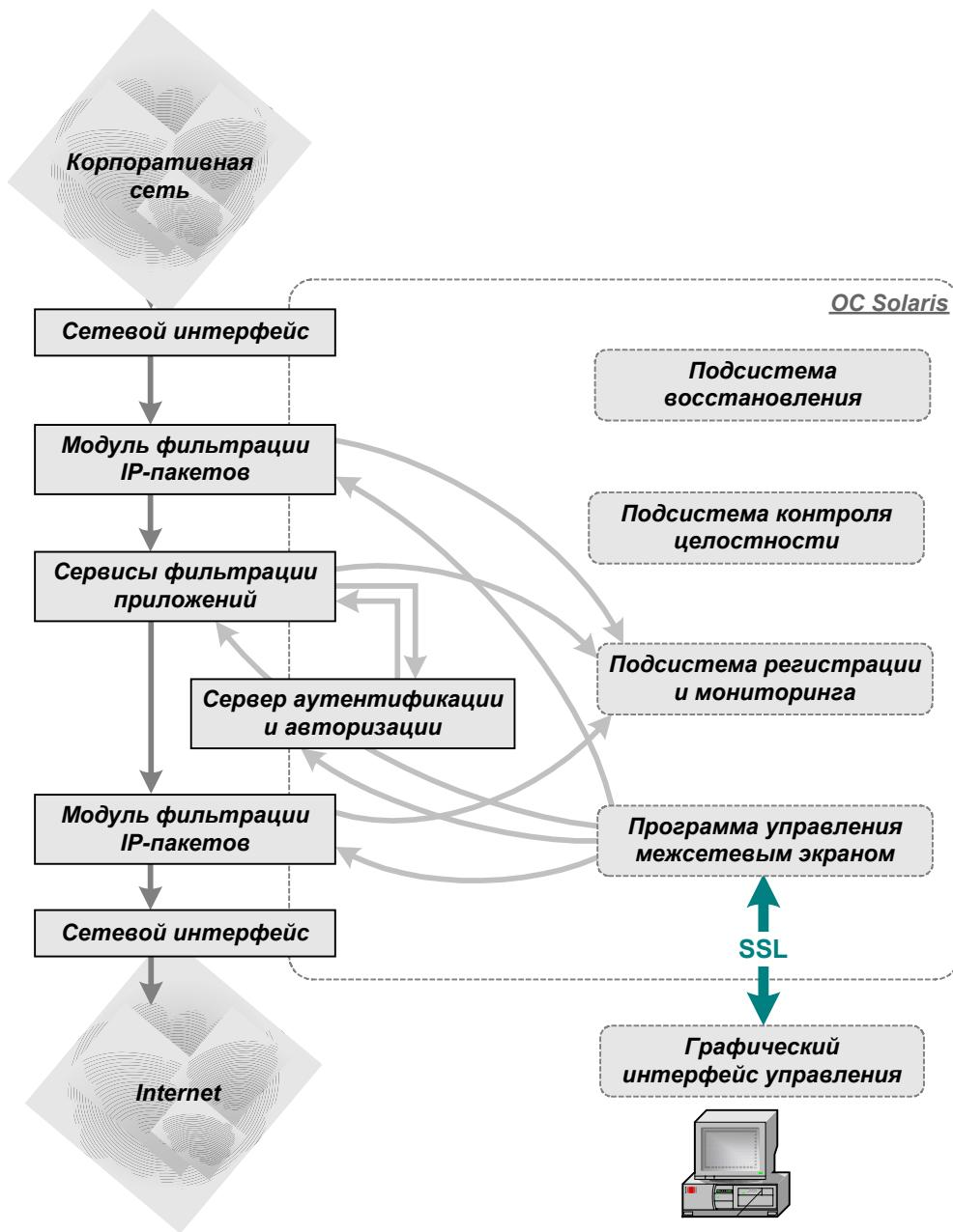
**Рис. 2. Схема взаимодействия основных компонент межсетевого экрана Z-2**
